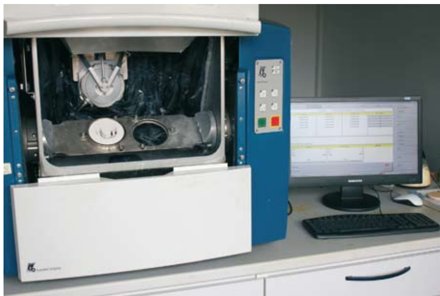
Bild 3: Die Kavo Everest Engine zählt für FDZ zu den besten Fräsmaschinen für den Dentalbereich. Besonders vorteilhaft sind ihre simultane Fünffachsigkeit und die Möglichkeit, Kühlschmierstoff einzusetzen
