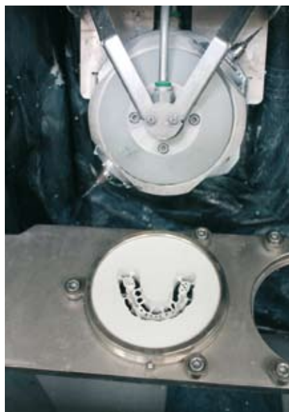
Bild 4: Mit WorkNC Dental programmiert und fünffachsig gefräst – die PEEK-Ronde wird nach der Bearbeitung gereinigt, verpackt und zum Kunden geschickt
